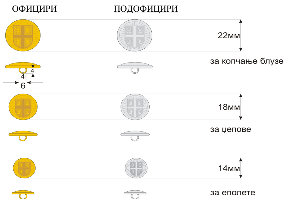
Слика 1 - Изглед, облик и димензије металне дугмади за службену и свечану униформу
